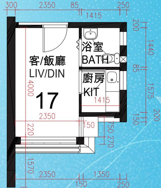
註：平面圖所列之數字為以毫米標示之建築結構尺寸。
